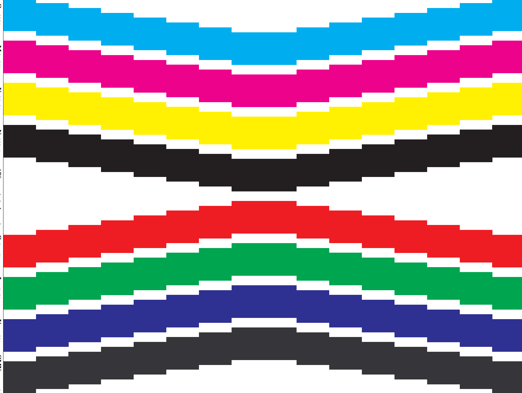
Bild 1: Farbfläche 14 mm x 14 mm; Ergiebigkeit / Emission: 40% geometrische Farbflächendeckung und 65% Farbdeckung; PS-Operator: cmy0* / 000n* setcmykcolor
