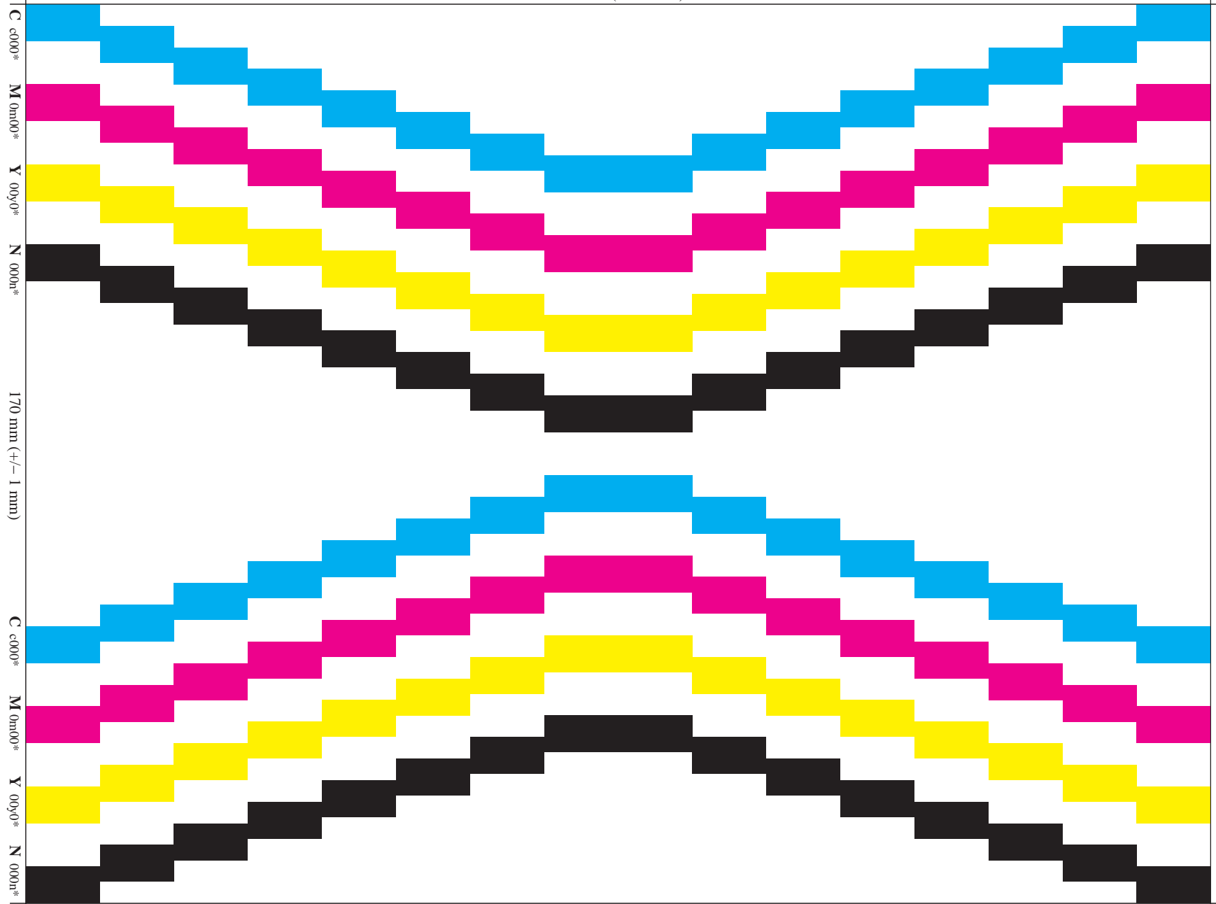
Bild 1: Farbfläche 14 mm x 7mm; Ergiebigkeit / Emission: 20% geometrische Farbflächendeckung und 20% visuelle Farbdeckung; PS-Operator: cmy0^* / 000n^* setcmykcolor BAM-Prüfvorlage Nr. BG74 Stufe: S2 input: cmy0^* / 000n^* setcmykcolor Ergiebigkeit/Emission: 20% Flächen-, 20% visuelle Farbdeckung output: cmy0^* / 000n^* setcmykcolor
