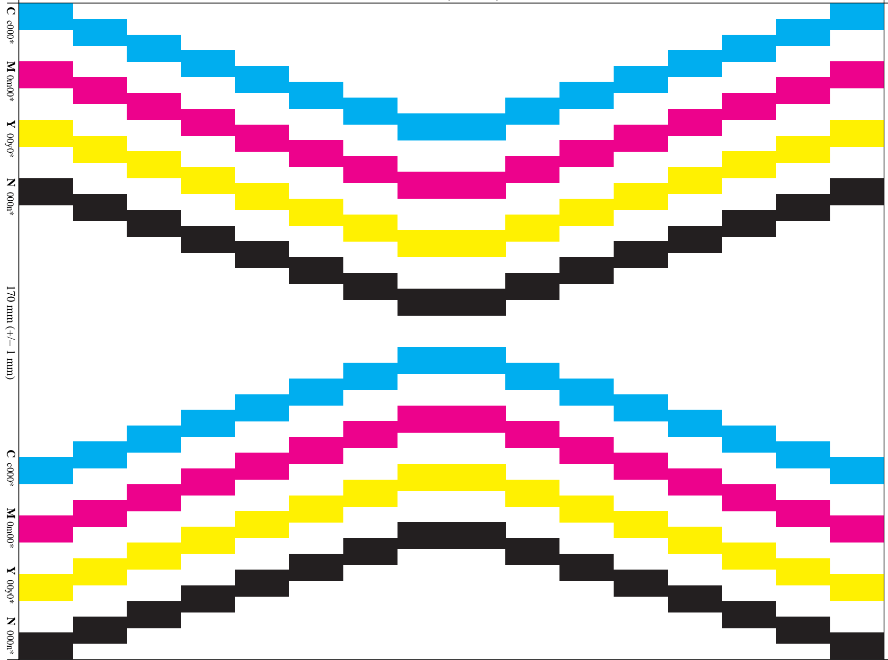
Bild 1: Farbfläche 14 mm x 7mm; Ergiebigkeit / Emission: 20% geometrische Farbflächendeckung und 20% visuelle Farbdeckung; PS-Operator: cmy0* / 000n* setcmycolor BAM-Prüfvorlage Nr. BG74 Stufe: S2 input: cmy0* / 000n* setcmykcolor Ergiebigkeit/Emission: 20% Flächen-, 20% visuelle Farbdeckungoutput: Startup (S) data depend
