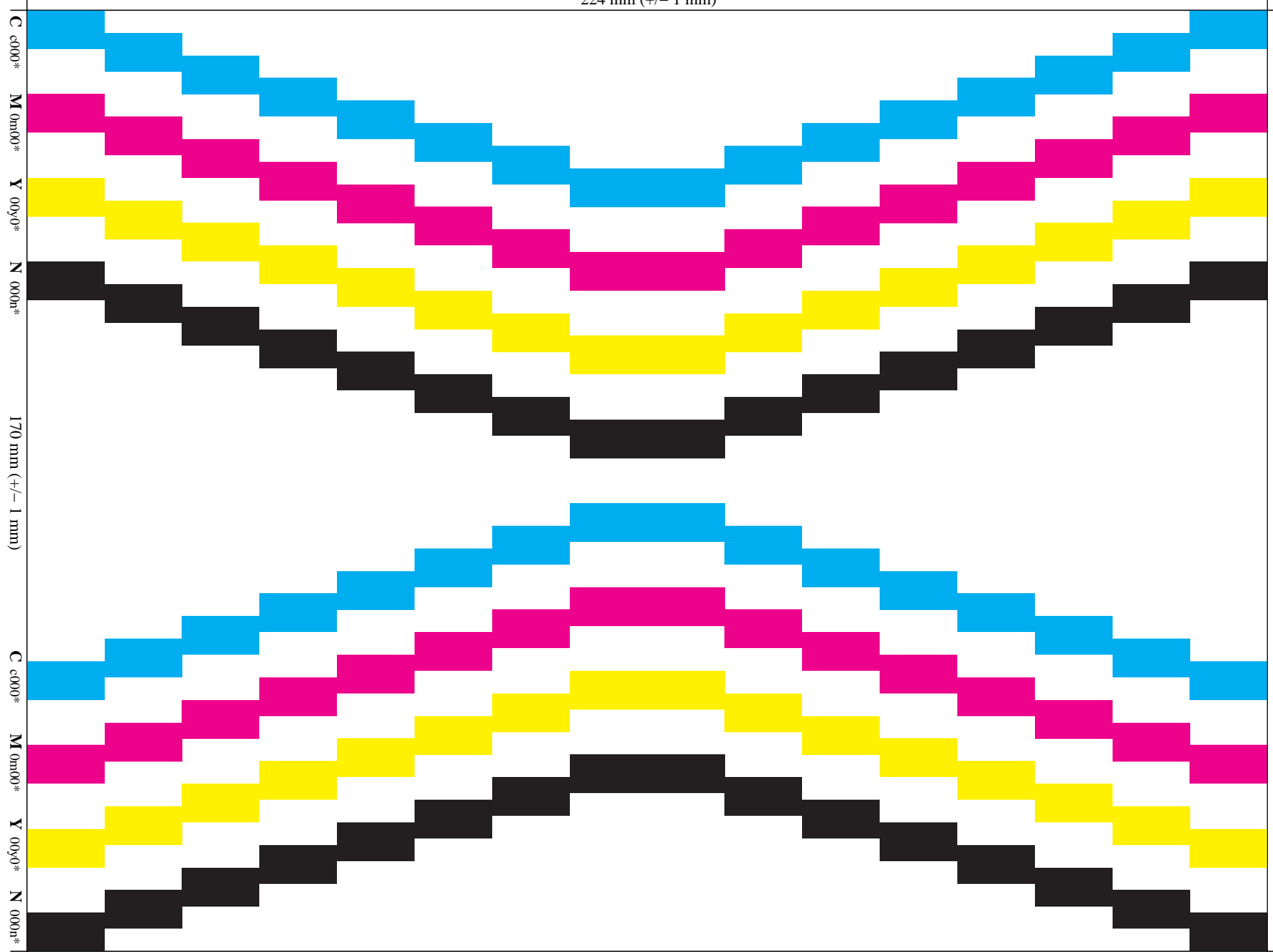
Bild 1: Farbfläche 14 mm x 7mm; Ergiebigkeit / Emission: 20% geometrische Farbflächendeckung und 20% visuelle Farbdeckung; PS-Operator: cmy0* / 000n* setcmykcolor
