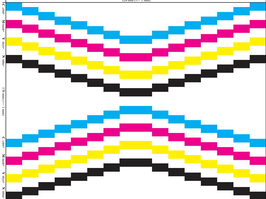
Bild 1: Farbfläche 14 mm x 7 mm; Ergiebigkeit / Emission: 20% geometrische Farbfächendeckung und 20% visuelle Farbdeckung; PS-Operator: cmy0* / 000n* setcmycolor BAM-Prüfvorlage Nr. BG74 Stufe: S1 input: cmy0* / 000n* setcmykcolor Ergiebigkeit/Emission: 20% Flächen-, 20% visuelle Farbdeckung output: no change compared to input
