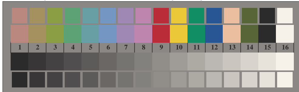
Bild B3: 14 CIE-Prüffarben sowie 2 + 16 Graustufen; Benutzung des PS-operators LAB* setcolor
