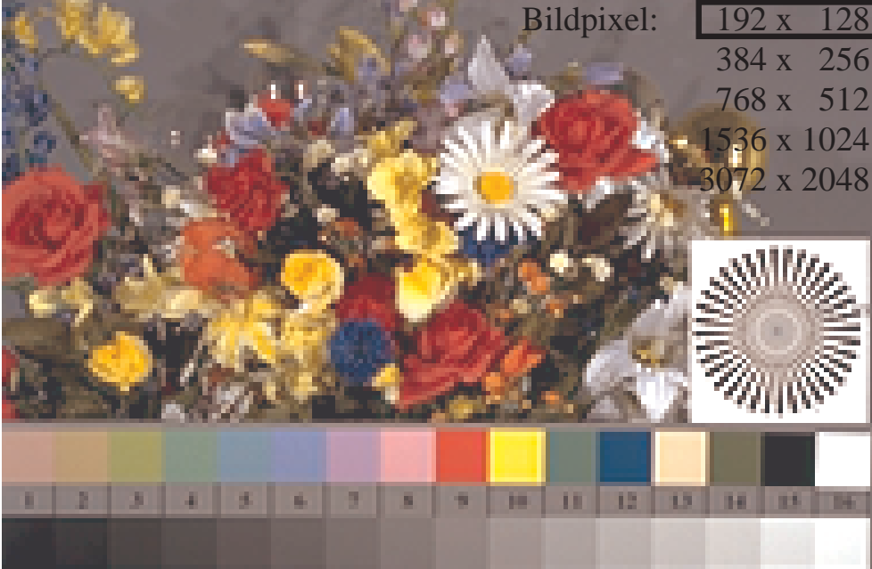
Bild B1: Blumenmotiv, 14 CIE-Prüfbarben sowie 2 + 16 Graustufen (sf); PS-Operatoren settransfer , 4 colorimage
