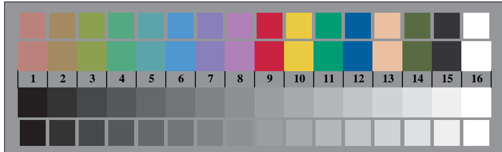
Bild B3: 14 CIE-Prüffarben sowie 2 + 16 Graustufen; PS-operator cmY0*/000n* setcmYcolor
