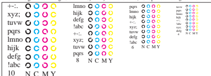
Bild B5: Schrift und Landoltringe N, M, C und Y; PS-Operator olv* setrgbcolor / w* setgray
