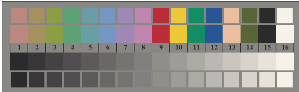
Bild D3: 14 CIE-Prüfbarben sowie 2 + 16 Graustufen; PS-Operator olv* setrgbcolor (only)
