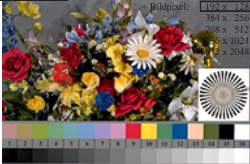
Bild D1: Blumenmotiv, 14 CIE-Prüffarben sowie 2 + 16 Graustufen (nf); PS-Operatoren settransfer , 3 colorimage
