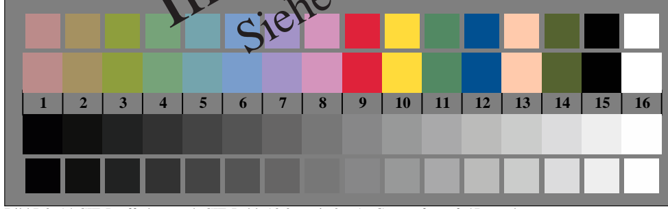
Bild D3: 14 CIE-Prüffarben nach CIE-Publ. 13.3 sowie 2 + 16 Graustufen; nf-*Daten benutzt
