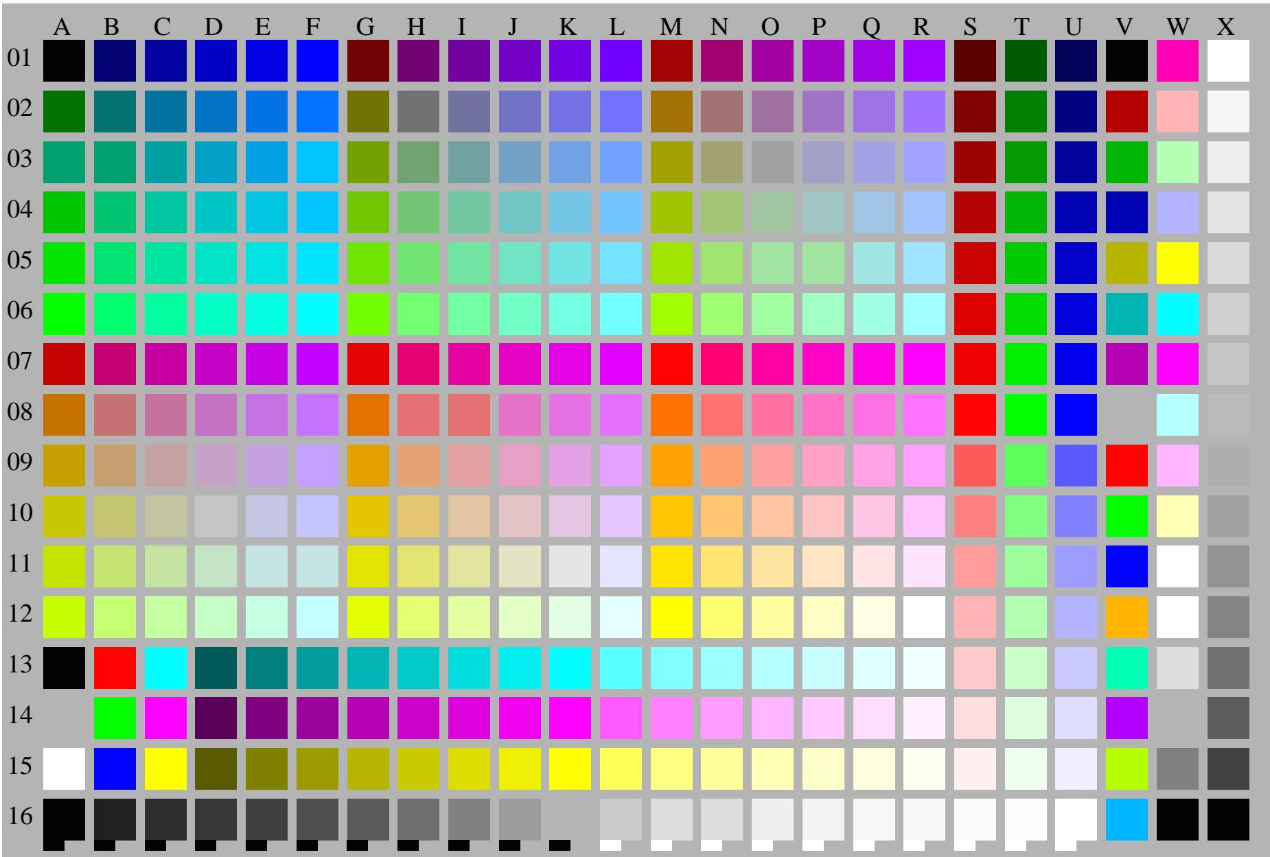
Prüfvorlagen-Datei mit 363 Farben sowie digital gleichabständige 5 und 16stufige Graureihe; siehe IEC 61966-7-1:1999 und ISO/IEC 15775:1999; rgb Farbkoordinaten, Mustergröße und graues Layout: 8mm x 8mm, 245mm x 163mm
