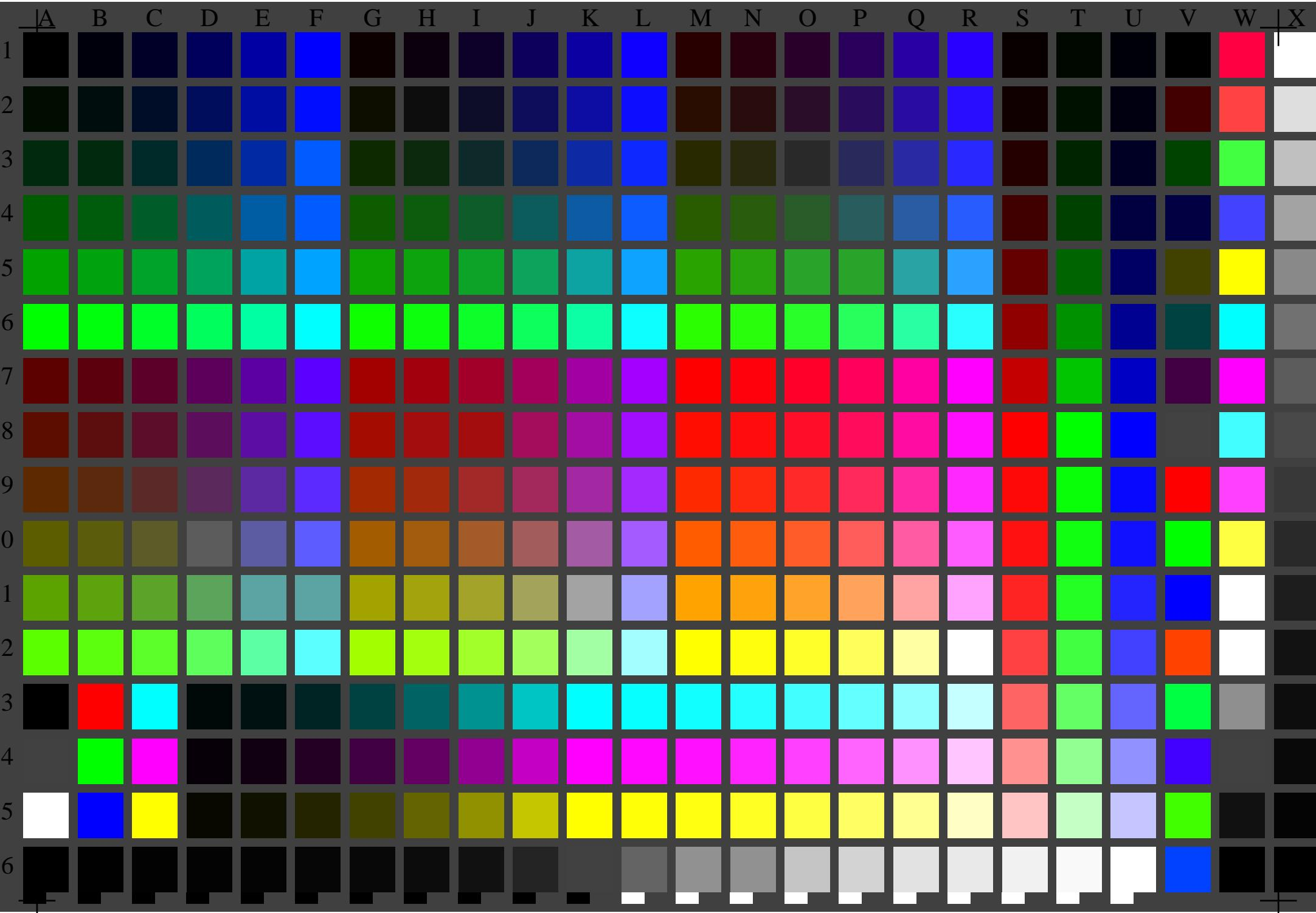
Prüfvorlagen-Datei mit 363 Farben sowie digital gleichabständige 5 und 16stufige Graureihe; siehe IEC 61966-7-1:1999 und ISO/IEC 15775:1999; rgb Farbkoordinaten, Mustergröße und graues Layout: 10mm x 10mm, 295mm x 198mm
