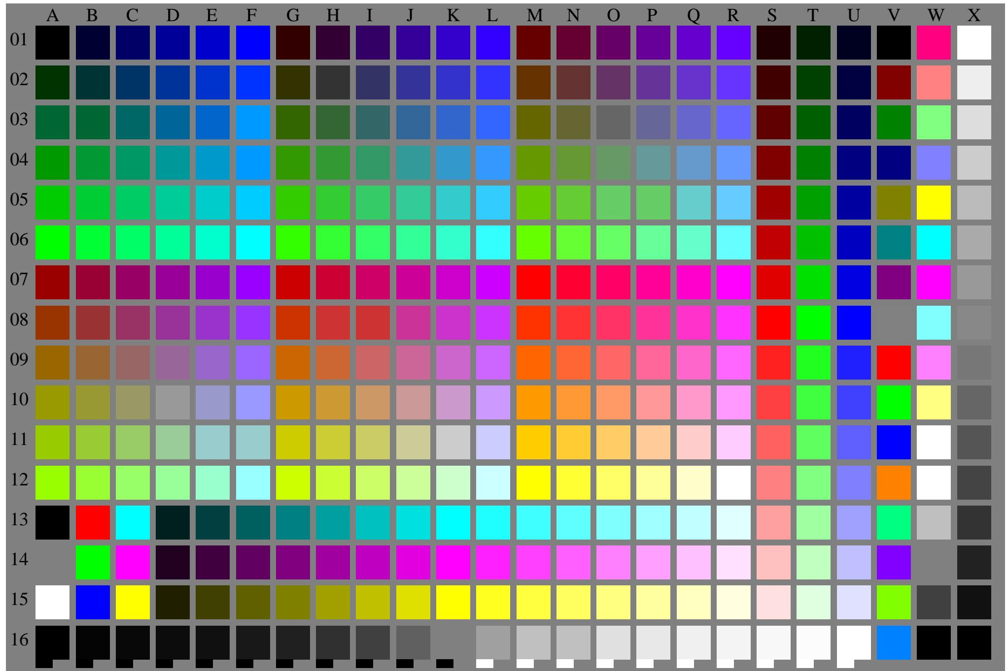
Prüfvorlagen-Datei mit 363 Farben sowie digital gleichabständige 5 und 16stufige Graureihe; siehe IEC 61966-7-1:1999 und ISO/IEC 15775:1999; rgb Farbkoordinaten, Mustergröße und graues Layout: 9mm x 9mm, 268mm x 180mm
