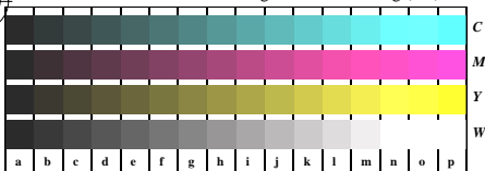
Bild B4n: 16 gleichabständige Stufen W-C, W-M, W-Y und W-N; PS operator LAB* setcolor
