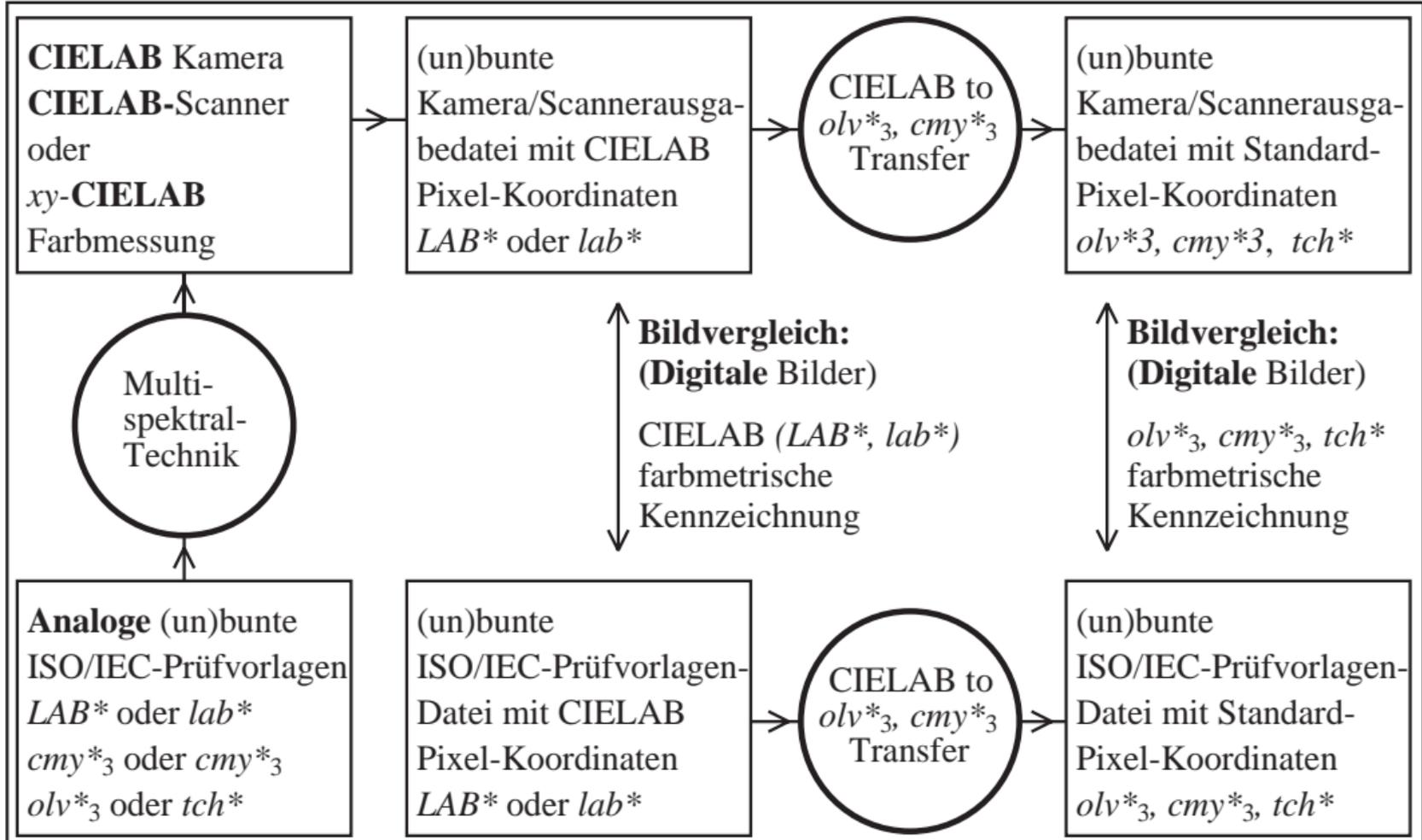
LG430-7, Transfer von geräteunabhängigen Daten  $LAB^*$  nach geräteabhängigen Daten  $olv^*_3$ ,  $cmy^*_3$  and  $tch^*$
