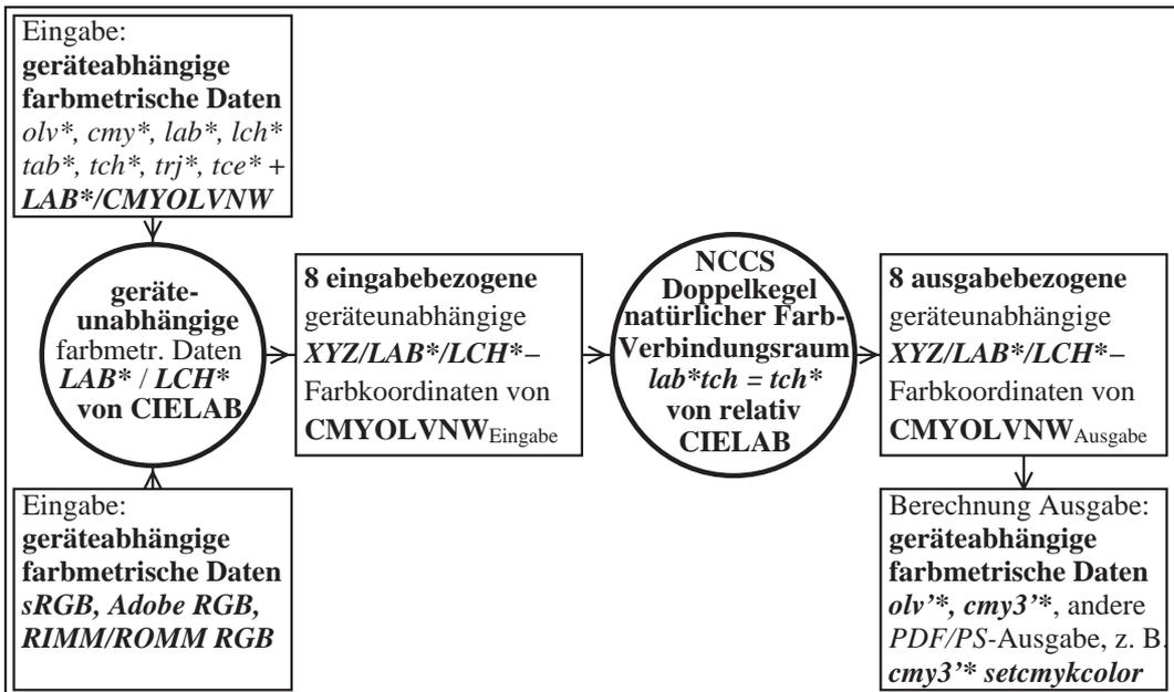
LG440-3, Transfer zu geräteunabhängigen  $LAB^*/LCH^*$  Daten; Ausgabe über natürlichen Farbverbindungsraum  $tab^*/tch^*$
