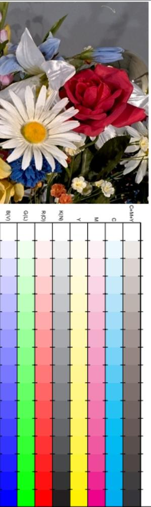
MG080-7, Bid 5: 16 gleichabständige Stufen für "Streifenbildung" und "Durchschlagen"
