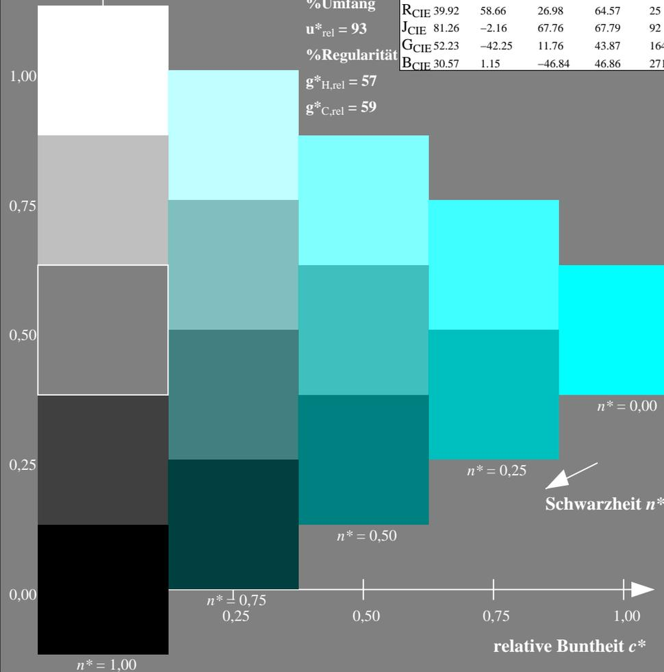
XG700-7N, 5stufige Reihen für konstanten CIELAB Buntton 236/360 = 0.656 (links)
