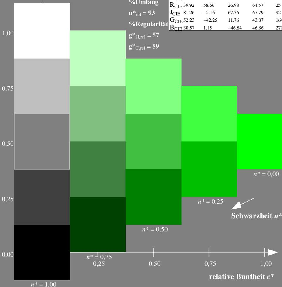
XG700-7N, 5stufige Reihen für konstanten CIELAB Buntton 151/360 = 0.419 (links)
