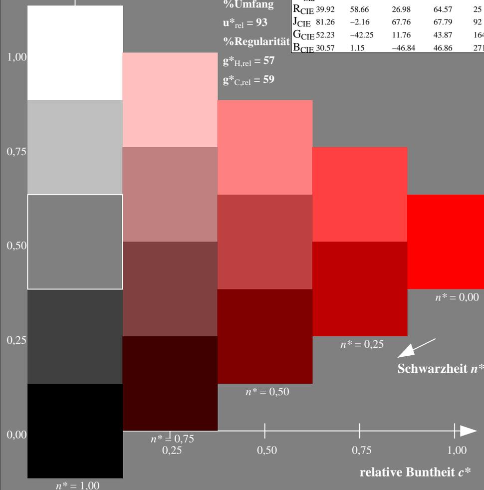
XG700-7N, 5stufige Reihen für konstanten CIELAB Buntton 38/360 = 0.105 (links)
