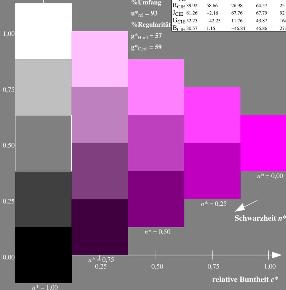
XG700-7N, 5stufige Reihen für konstanten CIELAB Buntton 354/360 = 0.982 (links)
