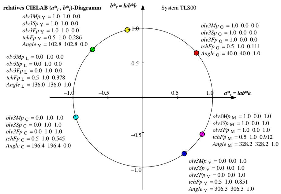
XG970-3. Relative CIELAB-Daten von sechs Standard-Fernsehfarben für sechs Bunttonwinkel; Daten  $lab^*olv3(M/S/F)$ ,  $LAB^*H$
