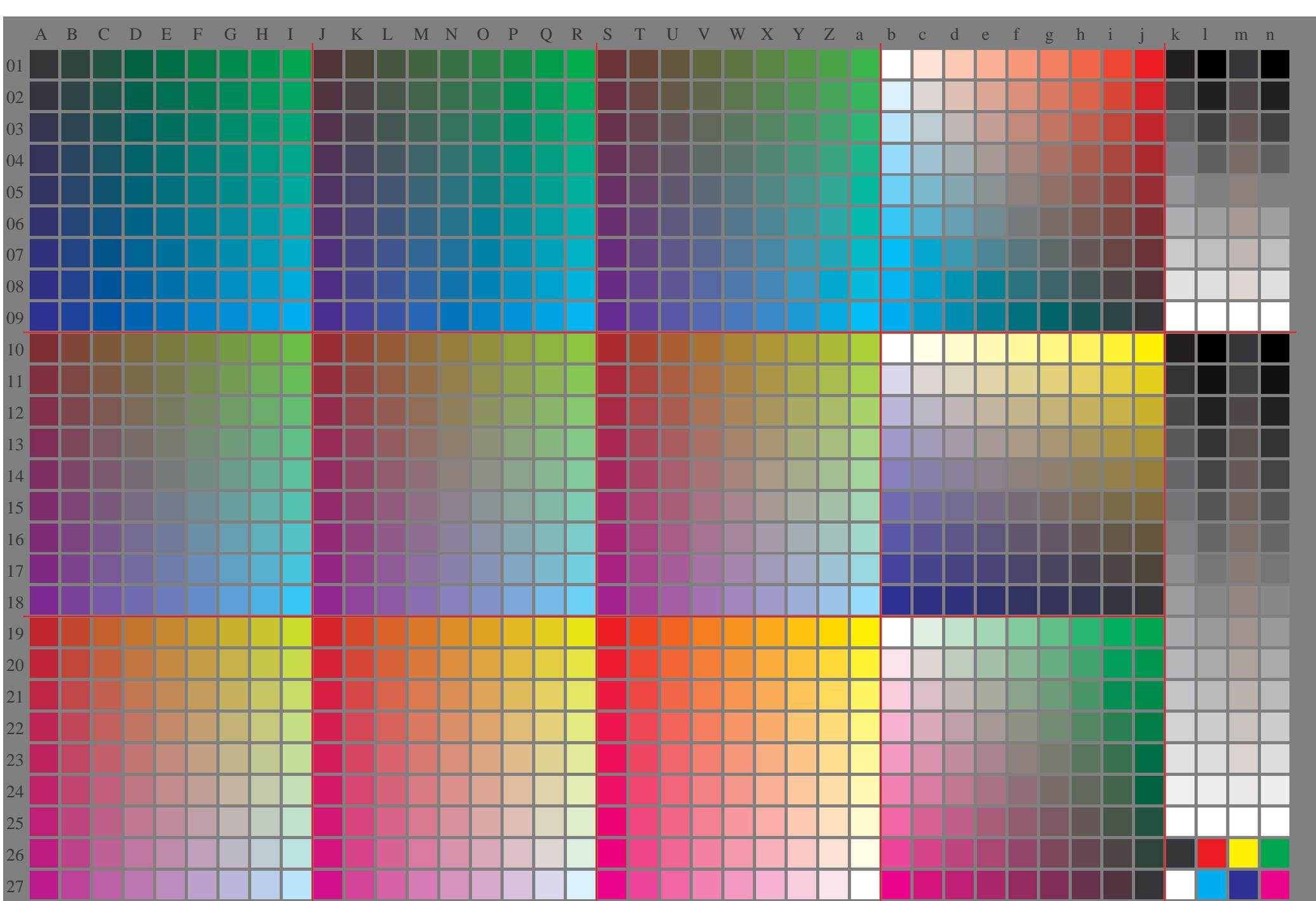
YG230-7N, Prüfvorlage mit 40x27=1080 Farben; digital gleichabständige 9stufige Farbreihen; vergleiche ISO/IEC 15775; cmy0-Farbdaten, Mustergröße und graues Layout: 6,0mm x 6,0mm, 275mm x 187mm, Seite 2/3
