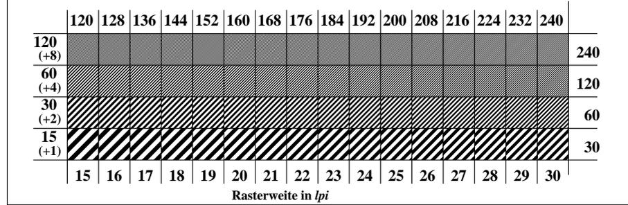
AG061-3, Bild A5W<sub>de</sub>: Element E: Linienraster unter 45° (oder 135°); PS-Operator: *rgb/cmy0/w/000n*
