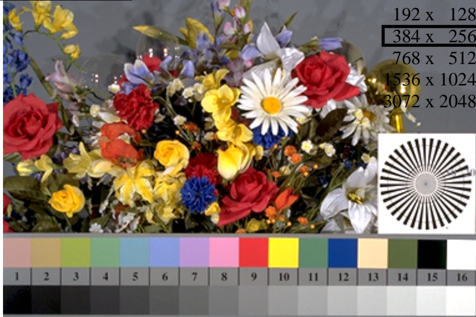
DFE00-3N, Fig. B1: Motif de fleurs, 14 couleurs test CIE et 16 marches de gris (sf); PS operators settransfer , 3 colorimage
