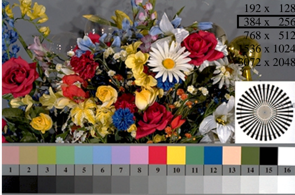
DFE10-3N, Fig. D1: Motif de fleurs, 14 couleurs test CIE et 16 marches de gris (nf); PS operators settransfer , 3 colorimage
