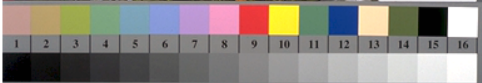
DGE00-3N, Bild B1: Blumenmotiv, 14 CIE-Prüffarben und 16 Graustufen (sf); PS-Operatoren settransfer , 3 colorimage
