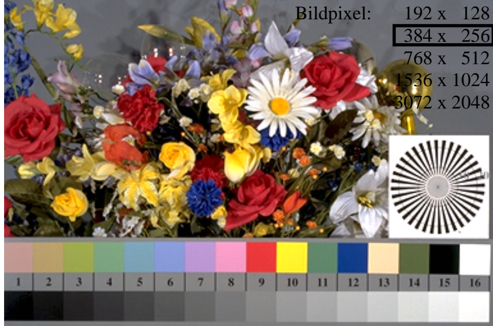
DGE00-3N, Bild B1: Blumenmotiv, 14 CIE-Prüffarben und 16 Graustufen (sf); PS-Operatoren settransfer , 3 colorimage
