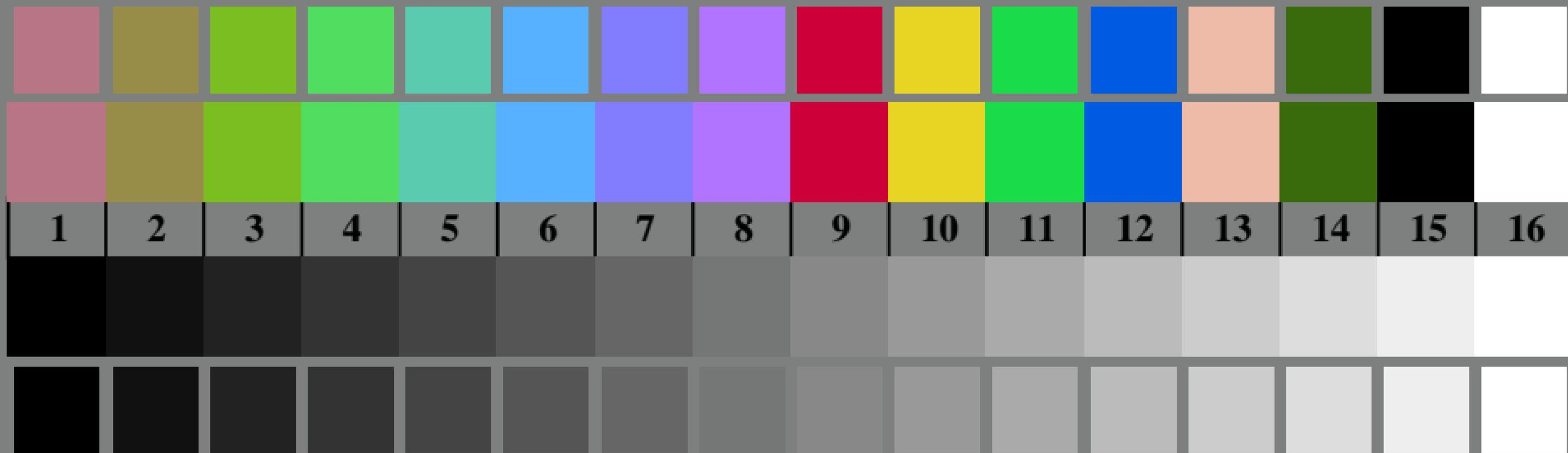
DGE50-7, Bild D3: 14 CIE-Prüffarben nach CIE 13.3 und 16 Graustufen
