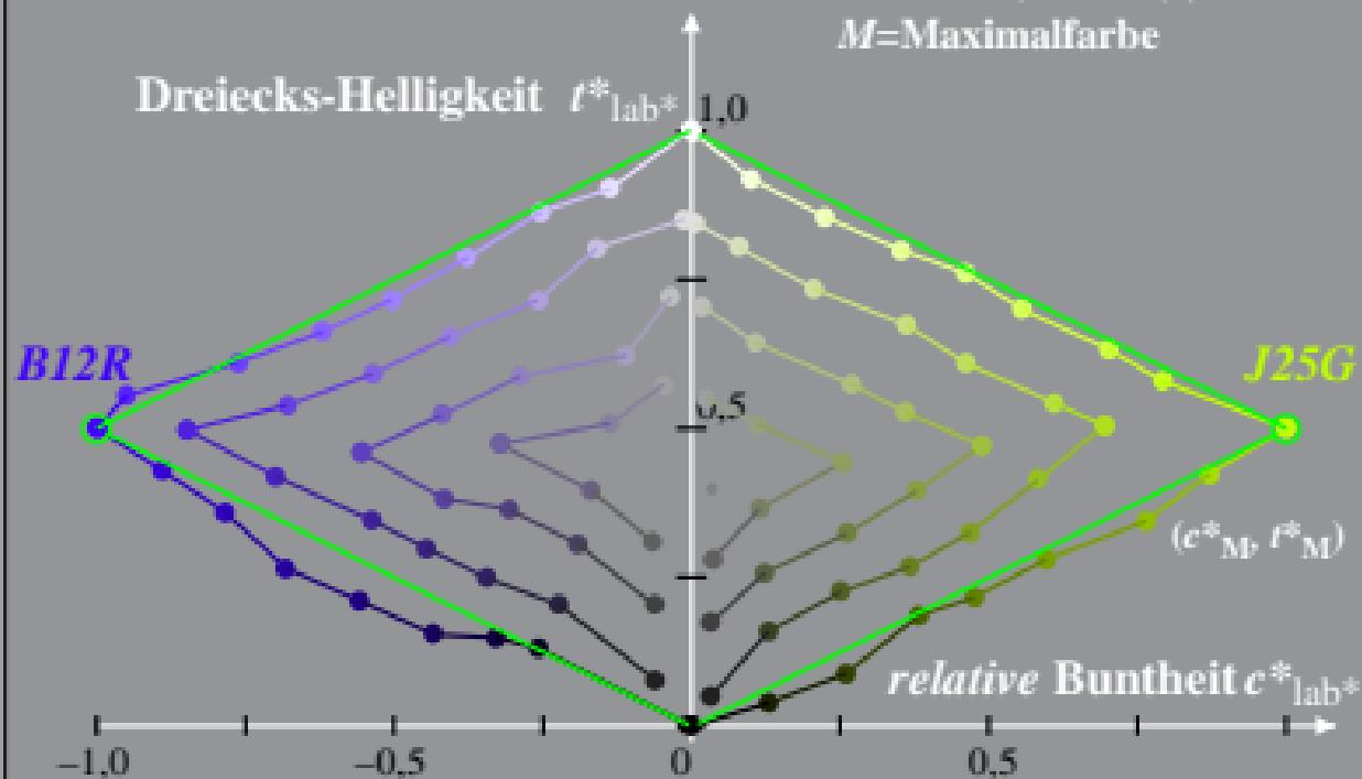
Beziehung adaptiertes (a) CIELAB ( $C^*_{ab,a}$ ,  $L^*$ ) und relatives CIELAB ( $c^*$ ,  $l^*$ ) System: HG83\_HRS16\_96\_D65\_50%\_O0
