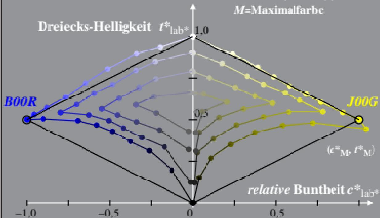
Beziehung adaptiertes (a) CIELAB ( $C^*_{ab,a}$ ,  $L^*$ ) und relatives CIELAB ( $c^*$ ,  $l^*$ ) System: HG83\_HRS16\_96\_D65\_00%\_01
