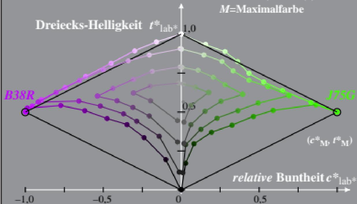
Beziehung adaptiertes (a) CIELAB ( $C^*_{ab,a}$ ,  $L^*$ ) und relatives CIELAB ( $c^*$ ,  $l^*$ ) System: HG83\_HRS16\_96\_D65\_75%\_01
