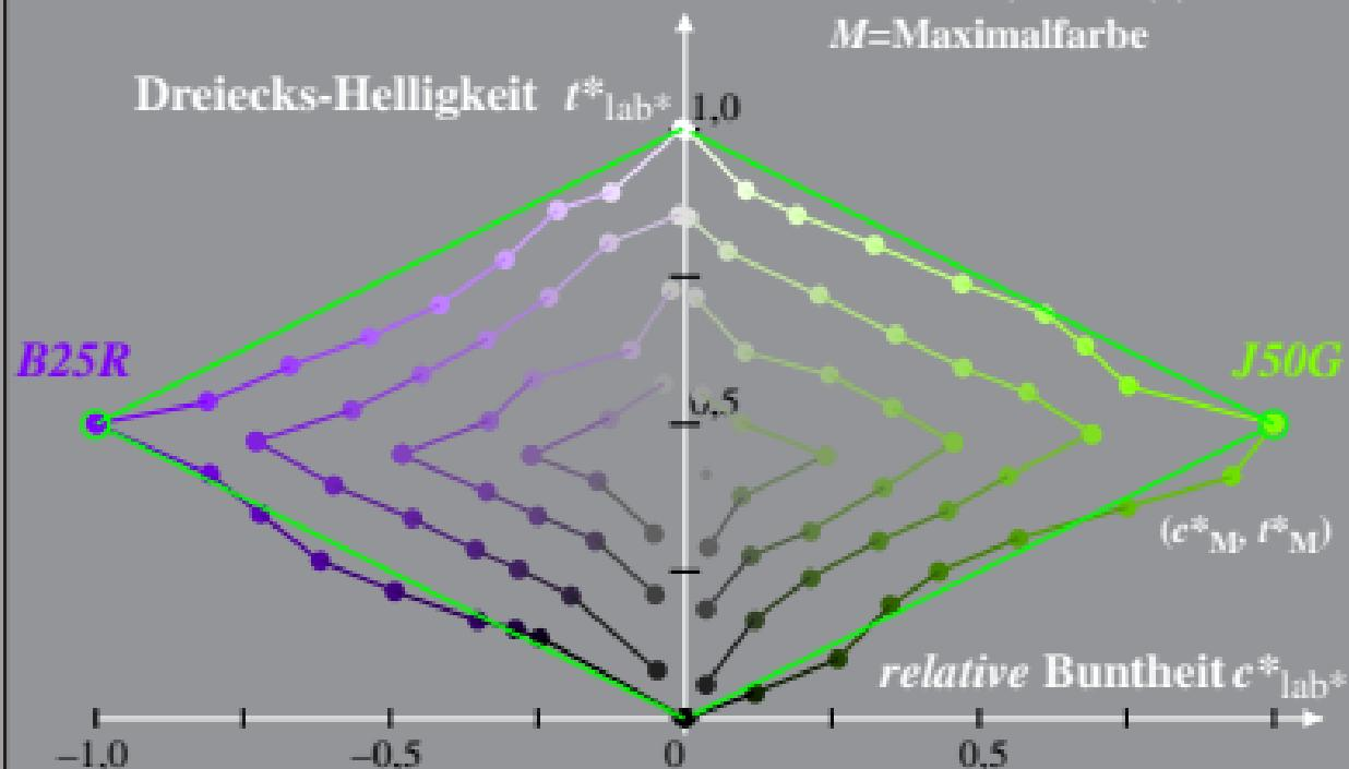
Beziehung adaptiertes (a) CIELAB ( $C^*_{ab,a}$ ,  $L^*$ ) und relatives CIELAB ( $c^*$ ,  $l^*$ ) System: HG83\_HRS16\_96\_D65\_75%\_O0
