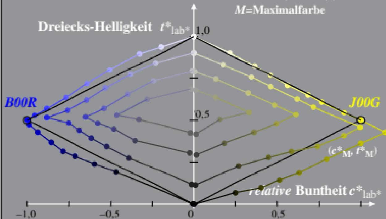
Beziehung adaptiertes (a) CIELAB ( $C^*_{ab,a}$ ,  $L^*$ ) und relatives CIELAB ( $c^*$ ,  $l^*$ ) System: HG95\_HRS16\_96\_D65\_00%\_01
