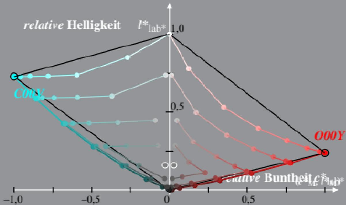
Adaptiertes (a) CIELAB ( $C^*_{ab,a}$ ,  $L^*$ ) und relatives CIELAB ( $c^*_{lab*}$ ,  $l^*_{lab*}$ )
