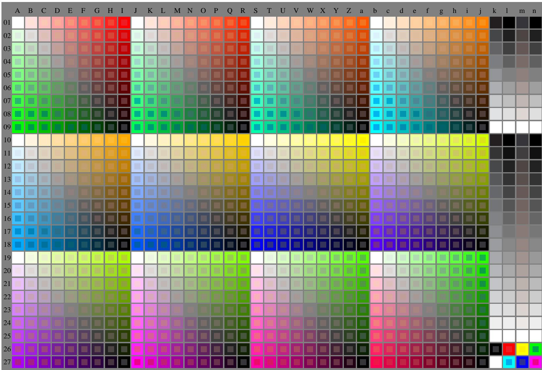
OG920-7N-030-0: Prüfvorlage 2e mit 40x27=1080 Farben; digital gleichabständige 9 oder 16stufige Farbreihen; Farbdaten in Spalte (A–n): **rgb / cmy0** (A<sub>j</sub> + k26\_n27), **000n** (k), **w** (l), **nnn0** (m), **www** (n), **colorml = 0**
