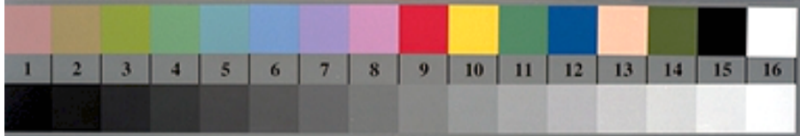
egb80-7n, Bild D1: Blumenmotiv, 14 CIE-Prüffarben und 16 Graustufen (nf); PS-Operatoren settransfer , 3 colorimage
