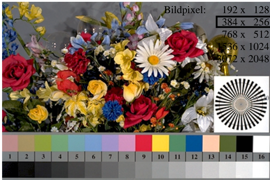
egb80-7n, Bild D1: Blumenmotiv, 14 CIE-Prüffarben und 16 Graustufen (nf); PS-Operatoren settransfer , 3 colorimage
