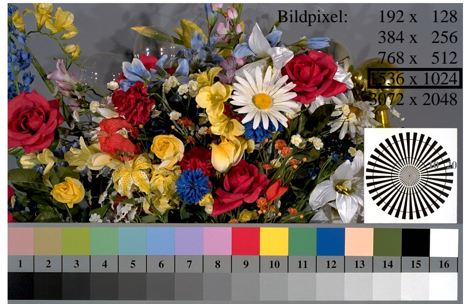
egb81-7n, Bild D1: Blumenmotiv, 14 CIE-Prüffarben und 16 Graustufen (nf); PS-Operatoren settransfer , 3 colorimage
