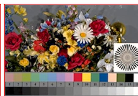
TUB-Prüfvorlage egc9; Beste visuelle Belichtung der Originalszene nach ISO/IEC 15775:2022
