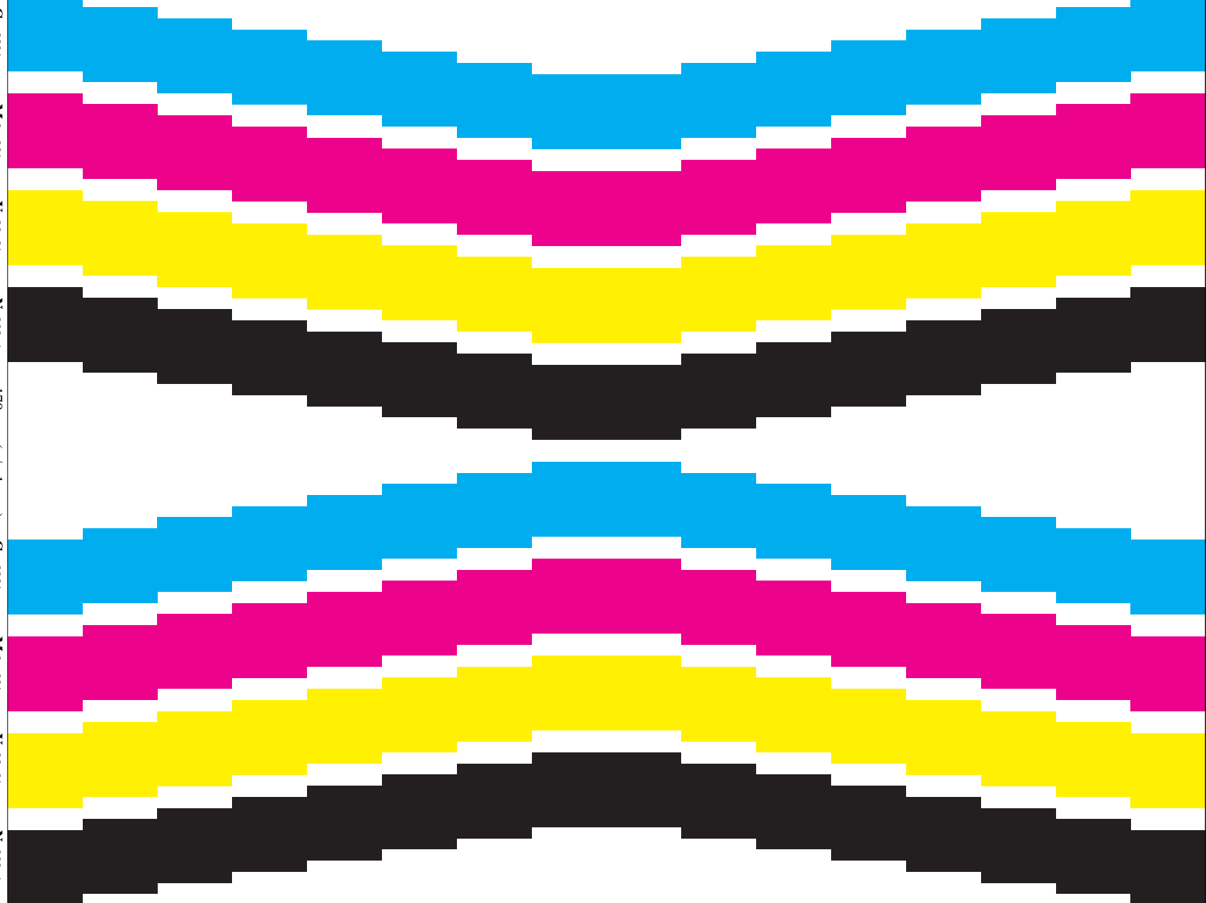
Bild 1: Farbfläche 14 mm x 14 mm; Ergiebigkeitstest: 40% geometrische Farbflächendeckung und 40% visuelle Farbdeckung
