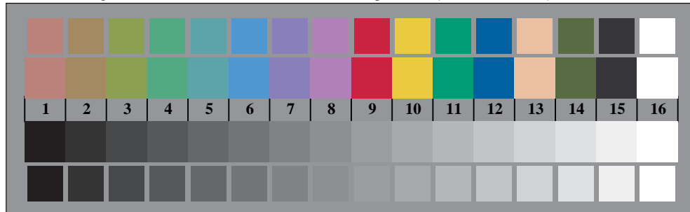
Bild B3: 14 CIE-Prüfbarben sowie 2 + 16 Graustufen; PS-operator cmY0*/000n* setcmYcolor
