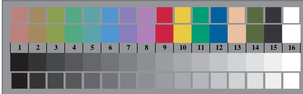
Bild B3: 14 CIE-Prüfbarben sowie 2 + 16 Graustufen; PS-operator cmY0*/000n* setcmYcolor
