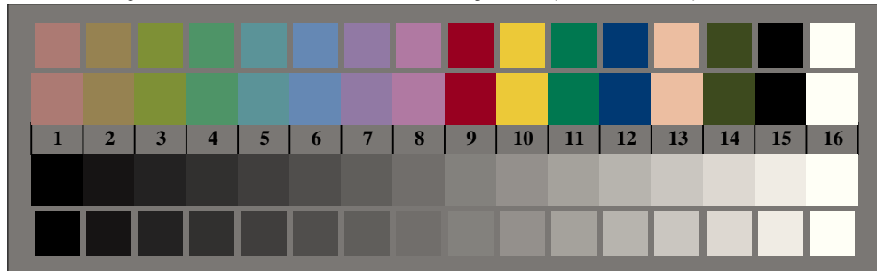
Bild B3: 14 CIE-Prüfbarben sowie 2 + 16 Graustufen; PS-operator cmly0*/000n* setmykcolor
