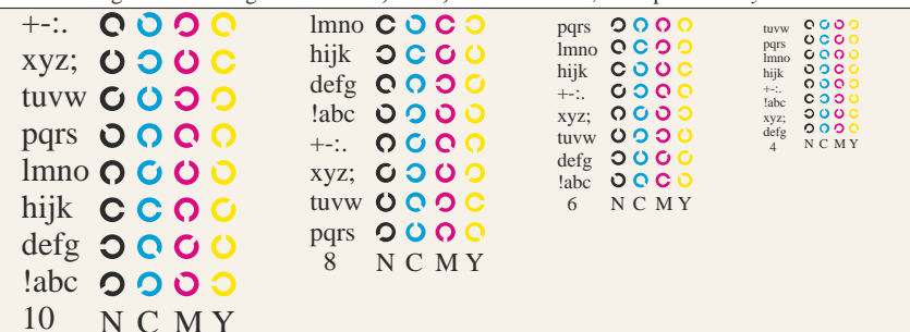
Bild B5: Schrift und Landoltringe N, M, C und Y; PS-Operator cmY0*/000n* setcmykcolor
