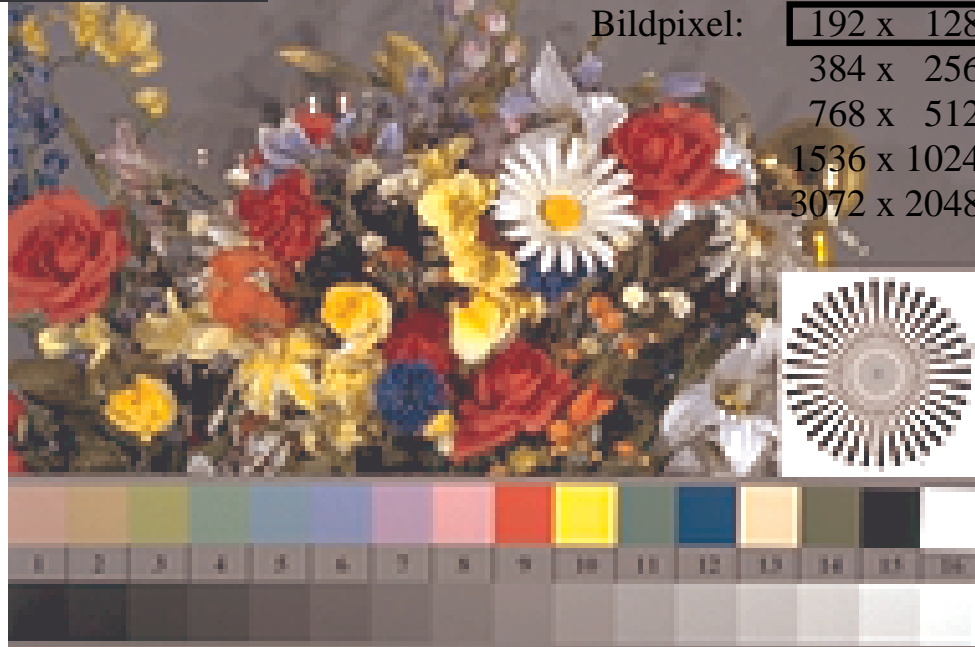
Bild B1: Blumenmotiv, 14 CIE-Prüfbarben sowie 2 + 16 Graustufen (sf); PS-Operatoren settransfer , 4 colorimage
