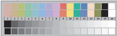
Bild B3: 14 CIE-Prüffarben sowie 2 + 16 Graustufen; PS-operator cmY0*/000n* setcmkycolor
