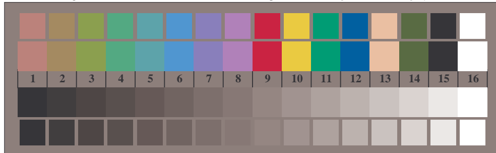
Bild B3: 14 CIE-Prüffarben sowie 2 + 16 Graustufen; PS-Operator olv* setrgbcolor / w* setgray
