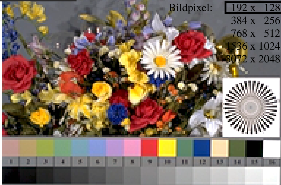
Bild B1: Blumenmotiv, 14 CIE-Prüffarben sowie 2 + 16 Graustufen (sf); PS-Operatoren settransfer , 3 colorimage
