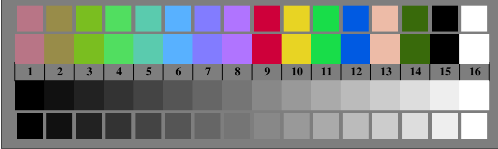
Bild B3: 14 CIE-Prüfbarben sowie 2 + 16 Graustufen; PS-Operator olv* setrgbcolor / w* setgray
