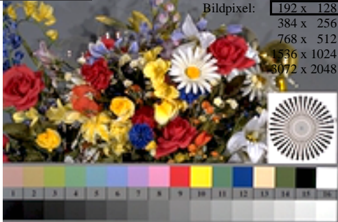
Bild B1: Blumenmotiv, 14 CIE-Prüffarben sowie 2 + 16 Graustufen (sf); PS-Operatoren settransfer , 3 colorimg
