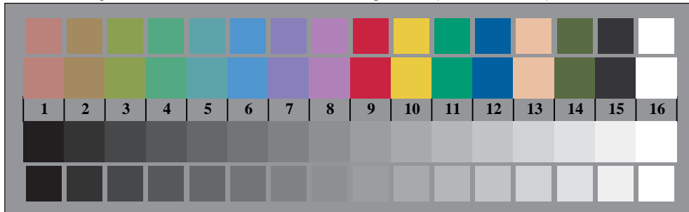
Bild B3: 14 CIE-Prüffarben sowie 2 + 16 Graustufen; Benutzung des PS-operators cmly0*/000n* setcmkcolor
