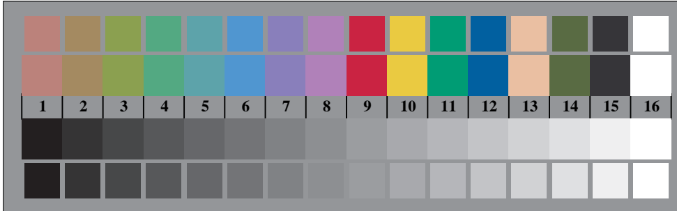
Bild B3: 14 CIE-Prüfbarben sowie 2 + 16 Graustufen; Benutzung des PS-operators cmly0*/000n* setcmlycolor
