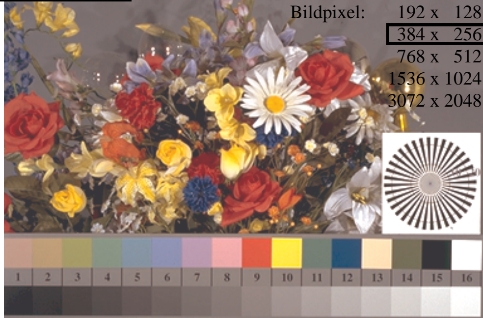
Bild B1: Blumenmotiv, 14 CIE-Prüffarben sowie 2 + 16 Graustufen (sf); PS-Operatoren settransfer , 4 colorimage
