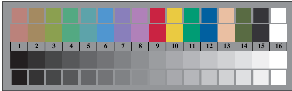
Bild B3: 14 CIE-Prüffarben sowie 2 + 16 Graustufen; Benutzung des PS-operators cmly0*/000n* setcmlycolor
