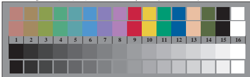
Bild B3: 14 CIE-Prüffarben sowie 2 + 16 Graustufen; Benutzung des PS-operators cmY0*/000n* setcmYcolor
